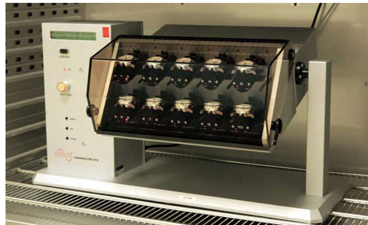
Chronometerprüfung: Die strengen Kriterien der DIN 8319-1, nach der LMET und SLME prüfen, schreiben eine 15-tägige Kontrolle vor
